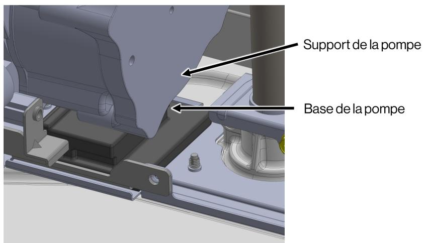
2. Connectez le coude de raccordement de la pompe à la nouvelle pompe à l'aide d'un (1) clip de fixation. Installez le remontage de la nouvelle pompe à l'intérieur du chauffe-eau et sécurisez-le avec deux (2) vis (Figure 3). Reconnectez les connecteurs bleus.
