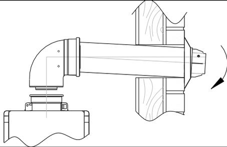
\* Le collecteur de condensats doit être utilisé pour les terminaisons horizontales si la montée verticale du système de ventilation dépasse 5 pieds (1,5 m).
