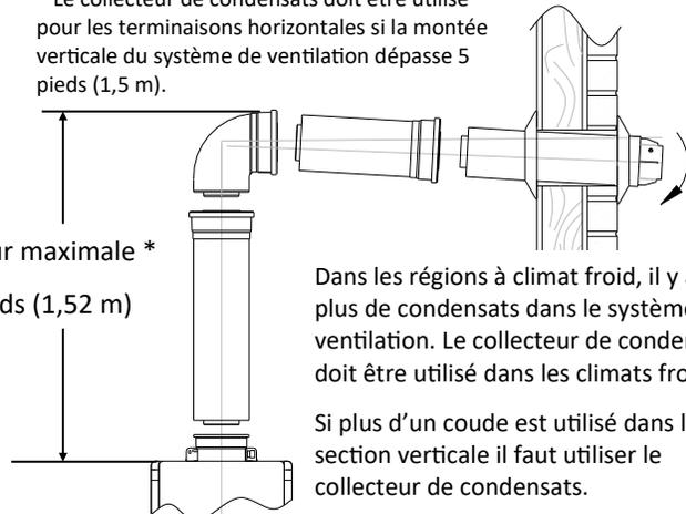
Dans les régions à climat froid, il y aura plus de condensats dans le système de ventilation. Le collecteur de condensats doit être utilisé dans les climats froids.
