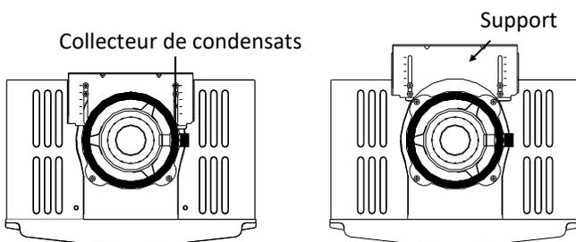
1. Desserrez les 4 vis au support arrière.
