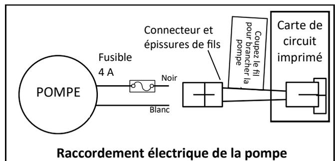
Raccordement électrique de la pompe
