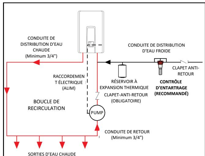
REMARQUE : N'installez PAS le système contrôle d'entartrage Rinnai au sein de la boucle de recirculation.
