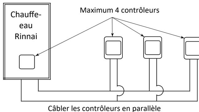
Ces 4 contrôleurs de température peuvent être constitués de plusieurs MC-91-2 ou MCC-91-2, mais d'un seul BC-100V et d'un seul MC-100V.
