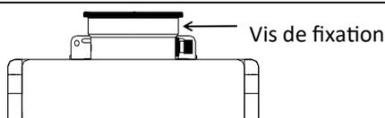
Fixez la première partie de ventilation branchée sur le chauffe-eau avec une vis autotaraudeuse à l'emplacement du trou au-dessus du collecteur de condensats.
