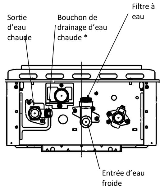
\* Utilisez une clé ou un autre outil pour dévisser le bouchon de drainage d'eau chaude.
