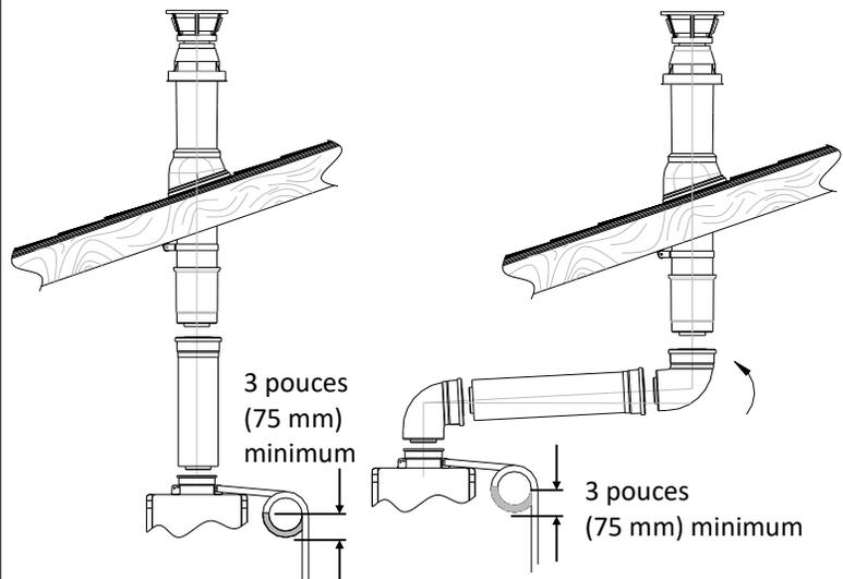
Pour ajuster la position du collecteur de condensats ou remplacer le haut de ventilation femelle par un mâle :
